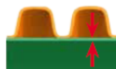
síla vnitřní stěny dle normy EN 13476-3
