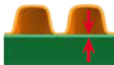
síla vnitřní stěny dle normy EN 13476-3
