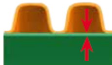
síla vnitřní stěny dle normy EN 13476-3
