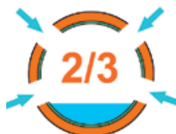
DN 250 - 400 mm Částečné drenážní potrubí
