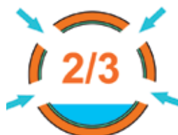
DN 250 - 400 mm Částečné drenážní potrubí
