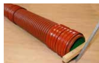
pak použijte prkno, které vložíte mezi potrubí a zařízení, které bude použito pro konečné doražení potrubí.
