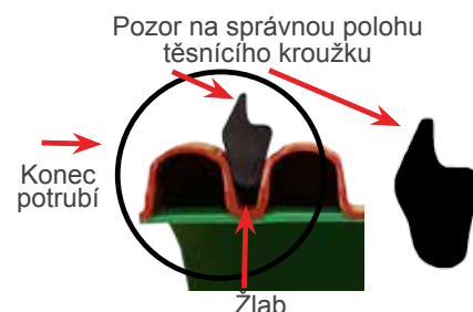
Montáž těsnícího kroužku
